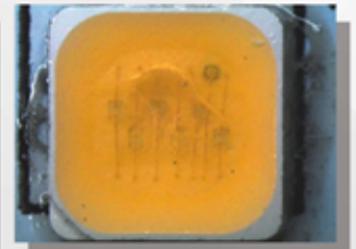
شکل ظاهری LED در اثر آسیب وجود رطوبت در آن
