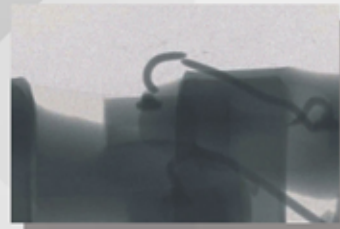
تصویر زیر عکس برداری X-Ray از LED است که در آن سیم اتصال چیپ قطع شده است.
